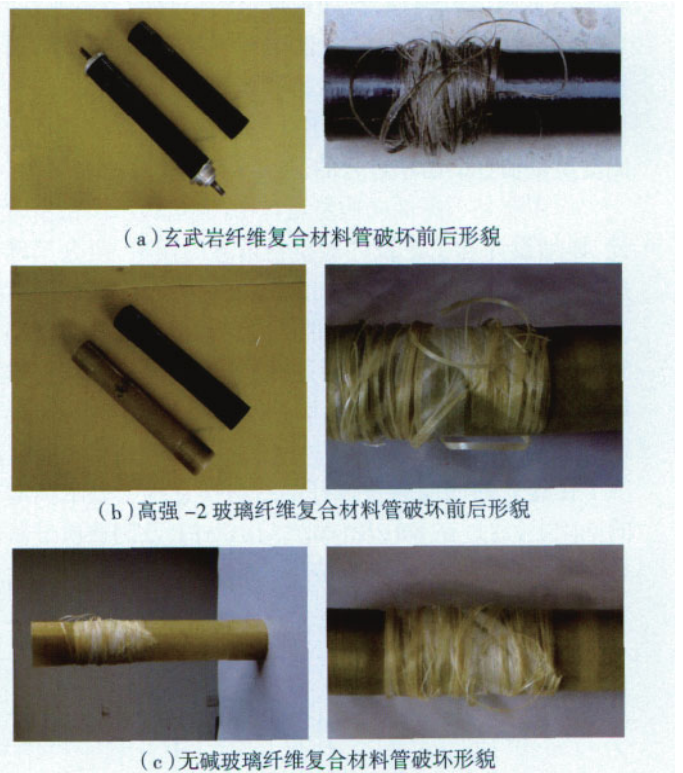
图3 玄武岩纤维复合材料管、高强-2纤维复合材料管及无碱纤维复合材料管破坏形貌 Fig.3 Destroy morphology of CBFC, SGC and EGC tubes
